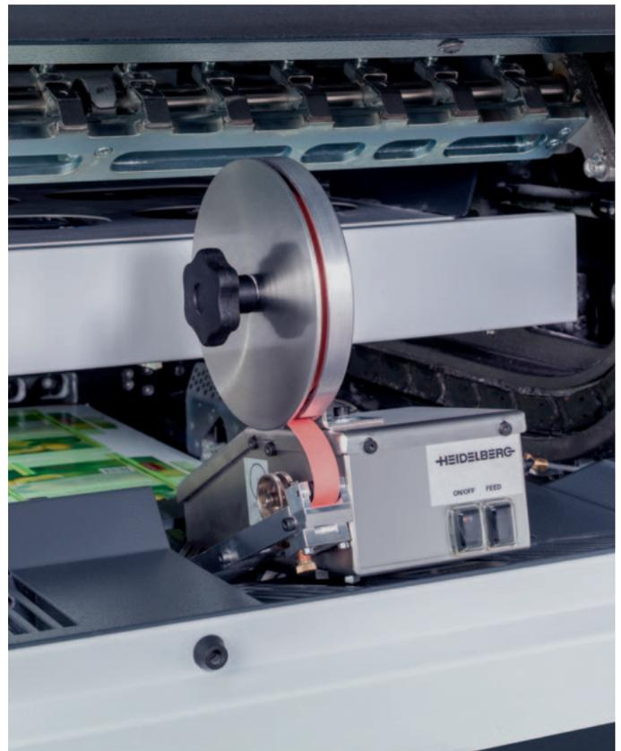
Streifeneinschießer InsertStar stirnseitig montiert.
