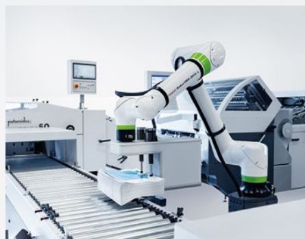
Kooperativní robot StackStar C automatizuje vykládání stohů složek na paletu.
