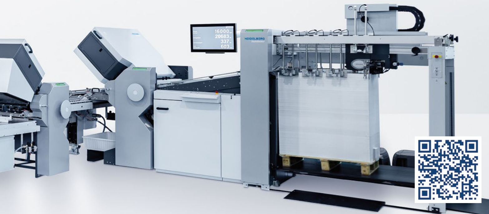
Kooperativní robot StackStar C automatizuje vykládání stohů složek na paletu.
