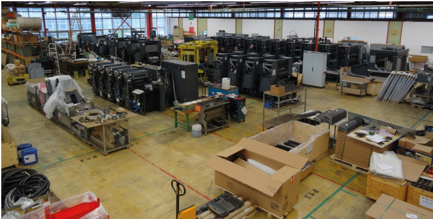
Repasovací centrum Techpark ve Vídni je specializovaným pracovištěm Heidelbergu pro střední Evropu. Rozkládá se na ploše 3500 m² a každý rok tu kompletní repasi projde asi 70 tiskových jednotek.
