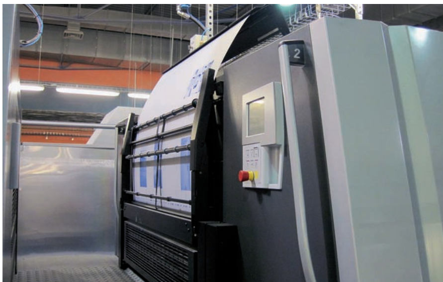
Systém AutoPlate XL pro plně automatizovanou synchronní výměnu tiskových desek je jedním z faktorů mimořádné produktivity stroje v přípravě na novou zakázku. V provozu tiskárny Finidr tak za jednu směnu zvládnou připravit a zpracovat až 38 zakázek!
