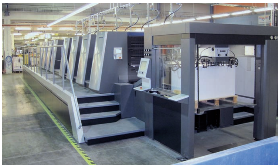
Nový tiskový stroj Speedmaster XL 106 zvyšuje produktivitu tisku ve Finidru průměrně o 35–40 %.
