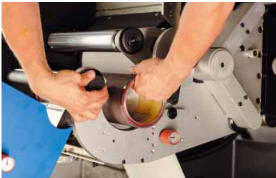
Výměna aniloxového válce na tiskovém stroji Gallus.
