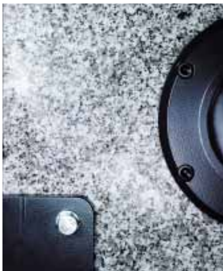
Konstrukce stroje je příznivá pro životní prostředí vzhledem k použití technické žuly.
