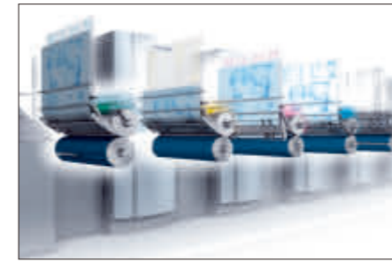
通过AutoPlate Pro全自动换版系统实现步进式印版更换——快速，轻松，全面自动化。
