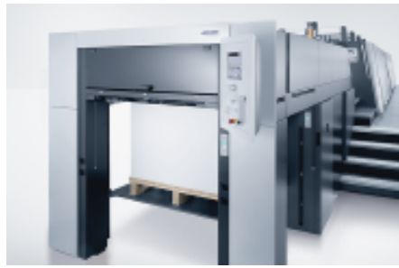
增强型预置收纸装置实现完美的纸堆码放，方便印后加工操作。
