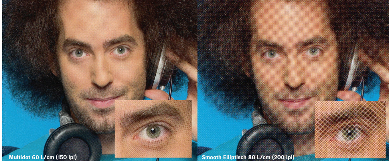
Abb. 3: Ein Vergleich zeigt, dass mit Multidot (links) bei lediglich 60 Linien pro Zentimeter deutlich homogenere Tonwertverläufe erzielt werden als mit einem AM-Raster bei 80 Linien pro Zentimeter.
