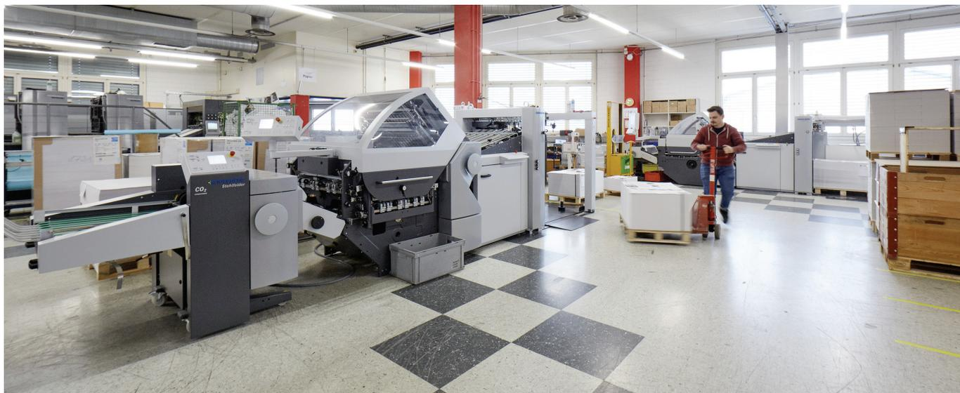
Dank der neuen Perfect-Grip-Falzwalzen erzielt die Cavelti AG auf dem Stahlfolder KH 78 unabhängig von den Papierqualitäten ausgezeichnete Falzergebnisse bei einer stabilen Laufleistung und hohen Produktionsgeschwindigkeiten.
