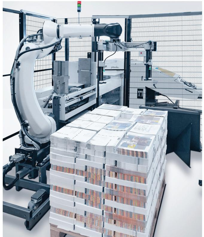
Der Stahlfolder P-Stacker setzt pro Stunde bis zu 300 Signaturenstapel dicht aneinandergereiht auf eine Palette ab.
