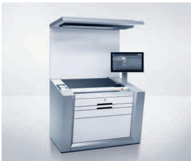
Le pilotage de la Speedmaster SX 52 s'opère depuis le poste de contrôle-commande Prinect Press Center 3. Le «Prinect Operating System» présentée sur l'écran 24 pouces et des assistants intelligents guident avec fiabilité l'imprimeur lors des opérations de préparation et de production.
