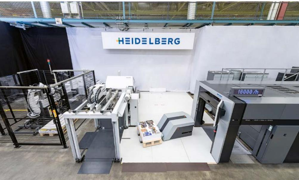
Mit einem bedienerlosen Transportsystem wird der fertig gedruckte Bogenstapel an die Falzmaschine Stahlfolder KH 82-P gefahren. Diese ist ebenfalls über das Push-to-Stop-Konzept integriert und erkennt die nächste Signatur automatisch am mitgedruckten Barcode.
