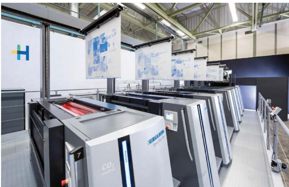
Mit Plate to Unit, der neuen vollautomatischen Druckplattenlogistik an der Druckmaschine, erfolgt die Bereitstellung der Druckplatten und deren Entsorgung komplett automatisiert.
