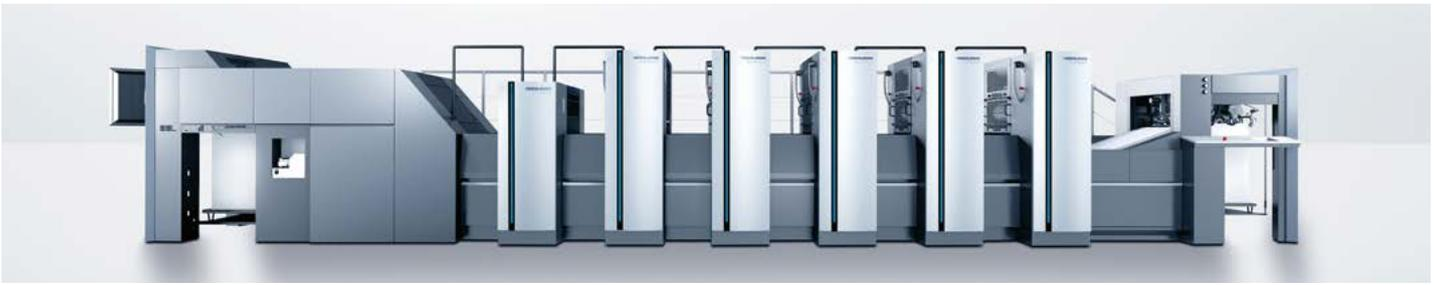
Als sogenannte Customized-Maschine ist die Speedmaster XL 75 fast beliebig mit Doppellackierwerken, unterschiedlichen Trocknersystemen, Kaltfolienmodulen und weiteren Komponenten konfigurierbar.
