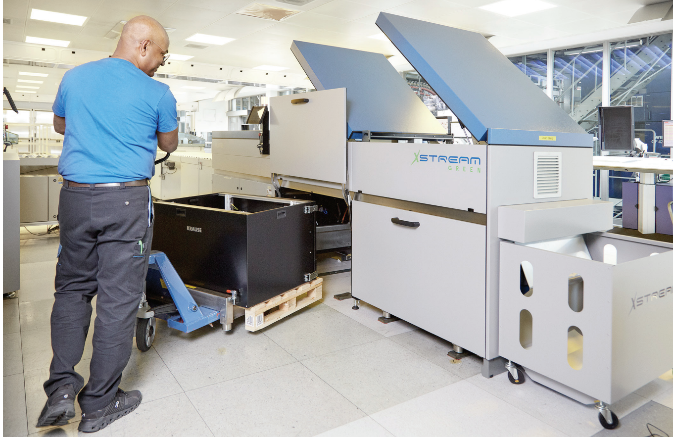
Der Palettenloader Krause APL weist ein Fassungsvermögen von 3000 Single- und 1500 Panoramaplatten auf und führt den Aussentrommelbelichtern die Druckplatten vollautomatisch zu.
