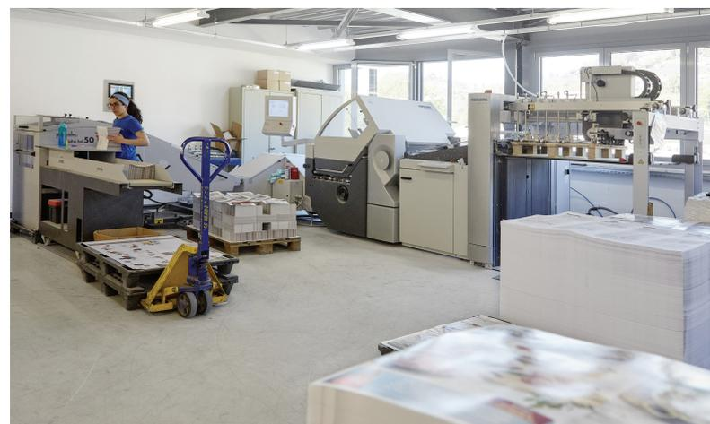
Dank der patentierten geschuppten Verarbeitung wird auf dem Stahlfolder KH 82-P die Produktionsleistung um bis zu fünfzig Prozent gesteigert.
