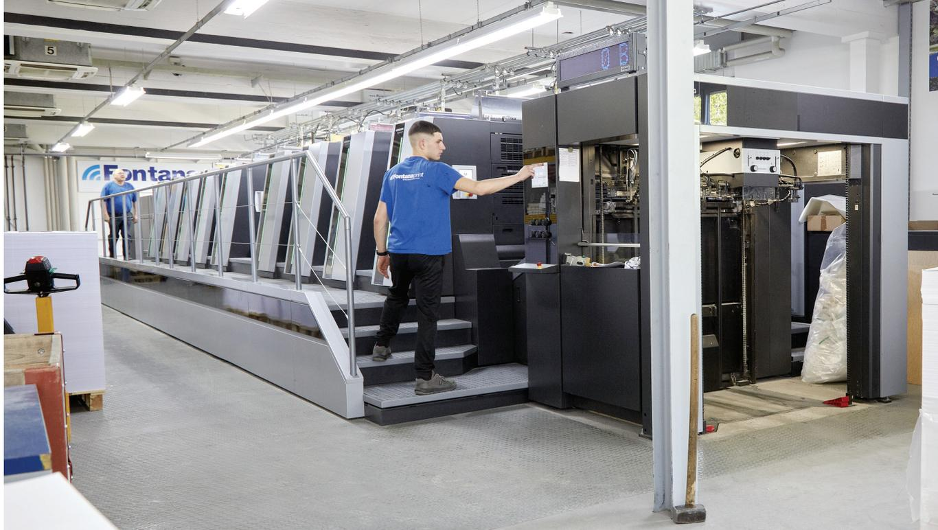
Mit der Inbetriebnahme einer Speedmaster XL 106 der neusten Drupa-Generation wechselte die Fontana Print SA von vormals zwei auf nur noch eine Bogenoffsetmaschine.
