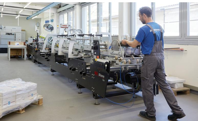
Die Faltschachtelklebemaschine Diana Go ermöglicht die Herstellung von Faltschachteln mit Längsnaht und mit Automatikboden (Faltboden).
