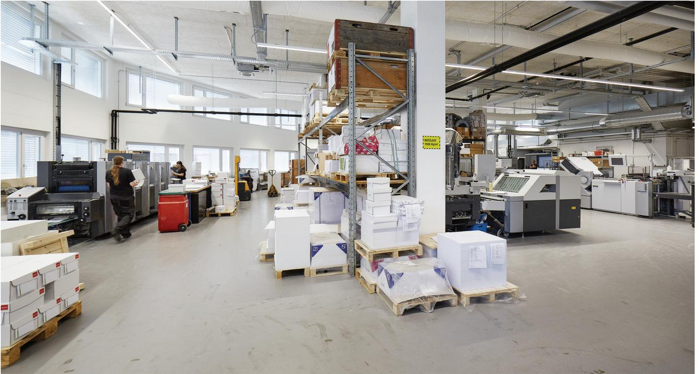
Am neuen Standort sind die Bogenoffsettechnik und die Weiterverarbeitung auf einer Ebene im Erdgeschoss angeordnet. Das Material wird ab dem Zeitpunkt seiner Anlieferung bis zu den versandbereiten Endprodukten ausschliesslich in einer Richtung bewegt.
