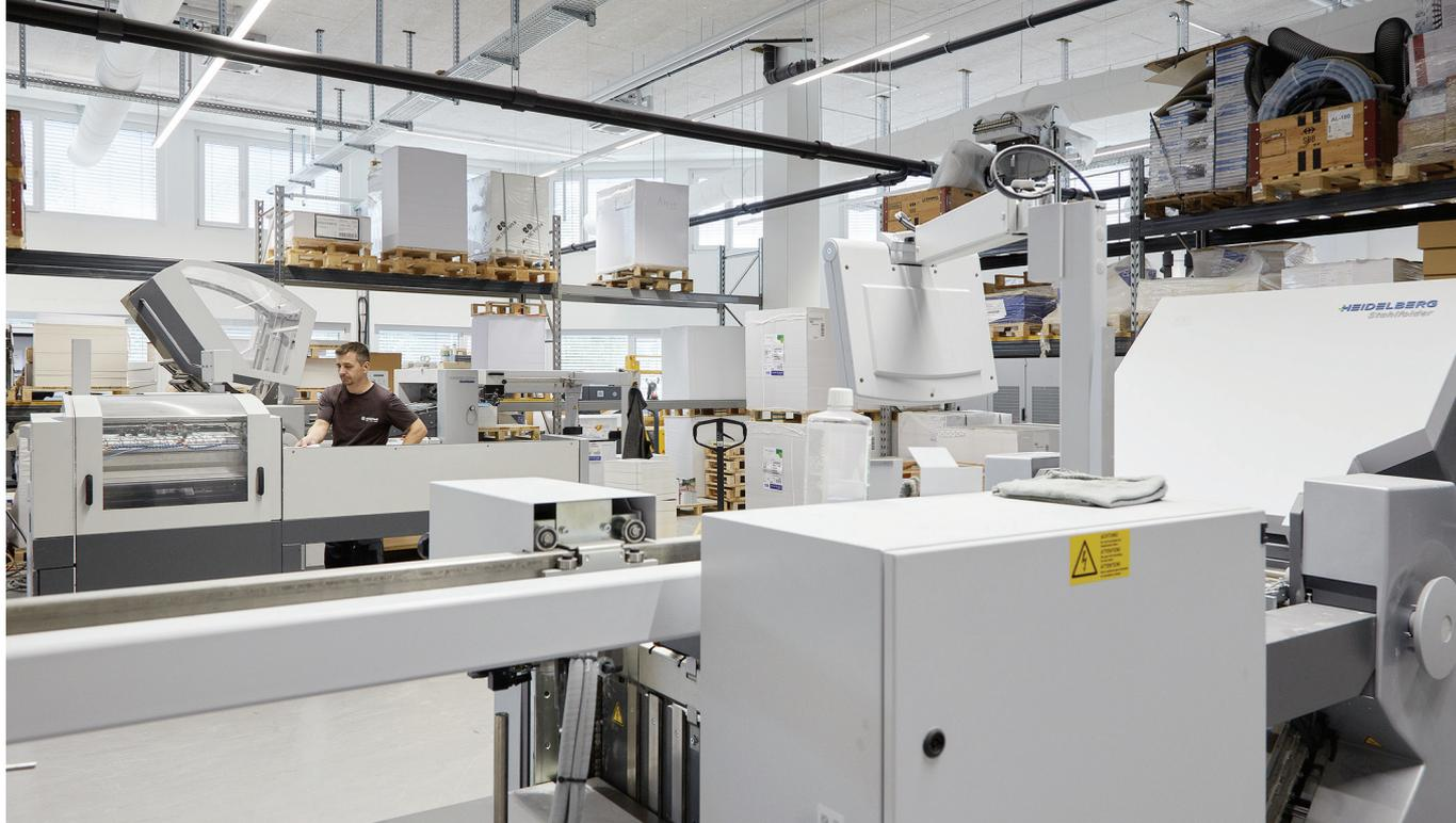
Die Weiterverarbeitung wurde erneuert. Neben dem Kauf einer neuen automatisierten Falzmaschine Stahlfolder TH 56-10 mit zehn Taschen wurde eine altgediente Kombifalzmaschine Stahlfolder KH 82-6 komplett revidiert.
