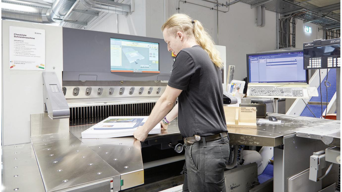
Auf der neuen Polar N 115 Autotrim berechnet Computcut die Schneidprogramme vollautomatisch.
