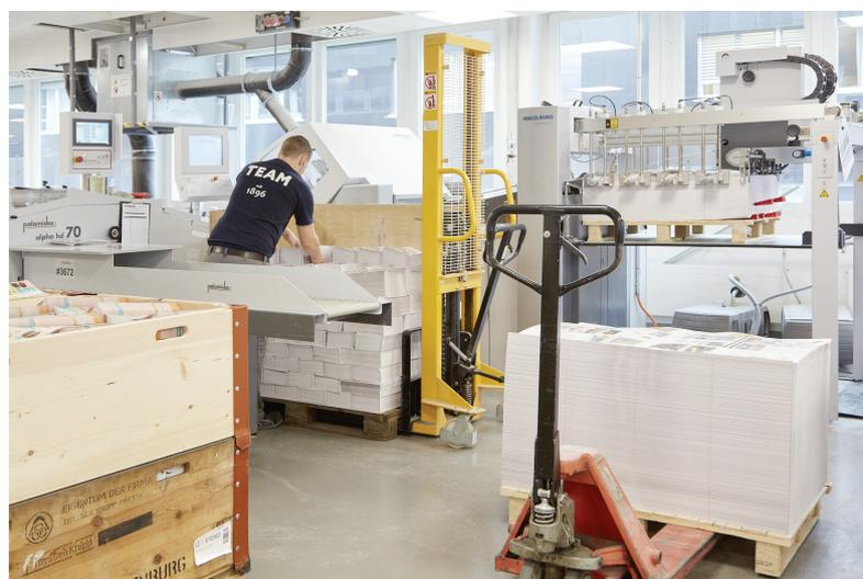
Von einem Suprasetter 106 über drei Speedmaster-Bogenoffsetmaschinen bis zu den Falzmaschinen – im Bild der Stahlfolder KH 82-P mit PFX-Anleger – deckt der Service- und Wartungsvertrag die gesamte Produktionstechnik von HEIDELBERG ab.
