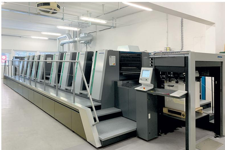
Mit der Speedmaster XL 75-8-P+L hat sich die Sparn Druck + Verlag AG für eine der modernsten und leistungsfähigsten Bogenoffsetdruckmaschinen ihrer Kategorie entschieden. Links: Am Prinect Press Center XL 3 führt das Speedmaster Operating System den Bediener systematisch durch alle Einrichte- und Produktionsabläufe.
