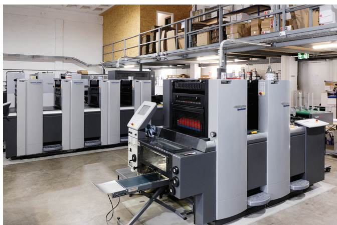
Trois équipements techniques de HEIDELBERG: la Speedmaster SM 52-2 au premier plan, la nouvelle Speedmaster SX 52-4 et, au fond, la Speedmaster SM 74-5.
