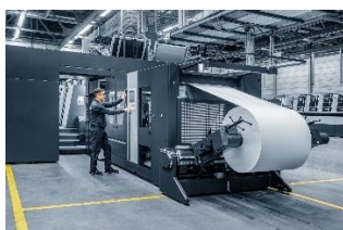
Figura 2: A tecnologia CutStar da HEIDELBERG possibilita o processamento de bobinas relativamente mais econômicas. Assim, mesmo as empresas tradicionais de impressão offset rotativa têm uma solução econômica para a produção de tiragens mais curtas.
