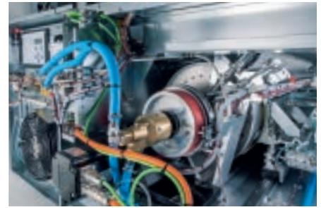
O sistema de controle de temperatura padroniza as condições de gravação das chapas.
