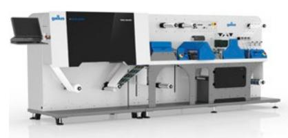
La **Gallus Smartfire** vous permet d'accéder en toute facilité au marché des étiquettes digitales. Le prix de cette presse numérique totalement équipée avec unité de finition est particulièrement intéressant. La machine se contente d'un raccordement simple à l'électricité et n'émet pas de composés organiques volatils (COV), ce qui rend inutile l'installation d'une unité d'aspiration. La Smartfire est une machine idéale pour tous les types d'environnement. Plug and print!
