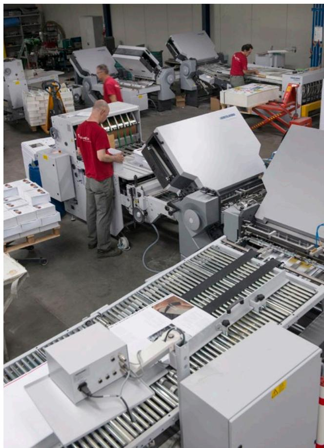
ration à l'expédition. Notre Stahlfolder TH 82 flexomailer s'intègre parfaitement dans cette mouvance: une configuration de pliage complétée d'applications spéciales comme le collage, le gommage, la fermeture par timbrage, le 'pick and place', l'adressage et la perforation. Aussi produisons-nous nombre de produits de direct mailing. »
